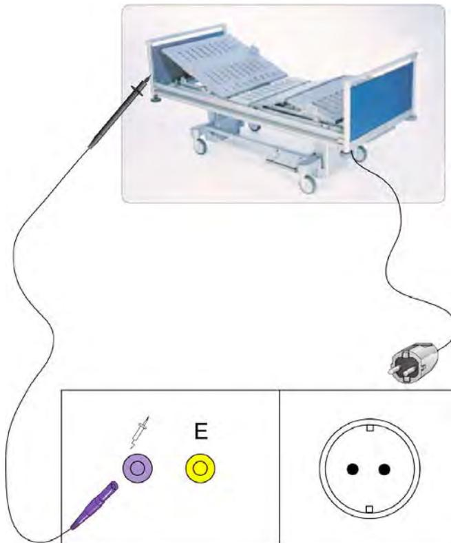
2. Anschluss von einphasigen fest angeschlossenen Geräten an das Prüfsystem
