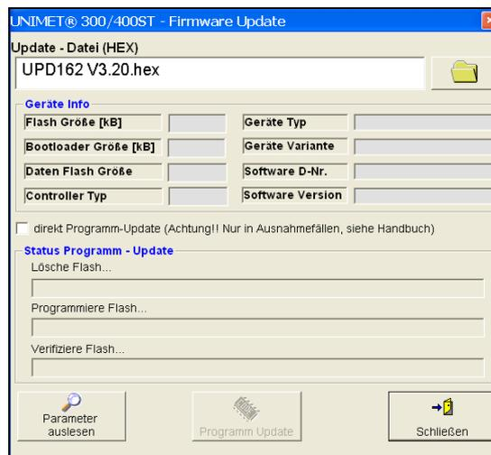
6. Die ausgelesenen Informationen werden angezeigt (Geräte Info). Klicken Sie auf die Schaltfläche "Programm Update". Der Flash-Speicher des UNIMET wird gelöscht, neu programmiert und anschließend geprüft (verifiziert). Der Fortschritt des Updates wird dargestellt.
