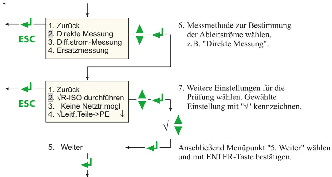
**R-ISO durchführen** Die Isolationsmessung legt eine Spannung von 500 V zwischen die aktiven Leiter und Erde. Empfindliche Geräte könnten durch die Isolationsprüfung beschädigt werden. Aktivieren Sie die Isolationsmessung nur, wenn die Herstellerangaben zum Prüfling dies zulassen.
