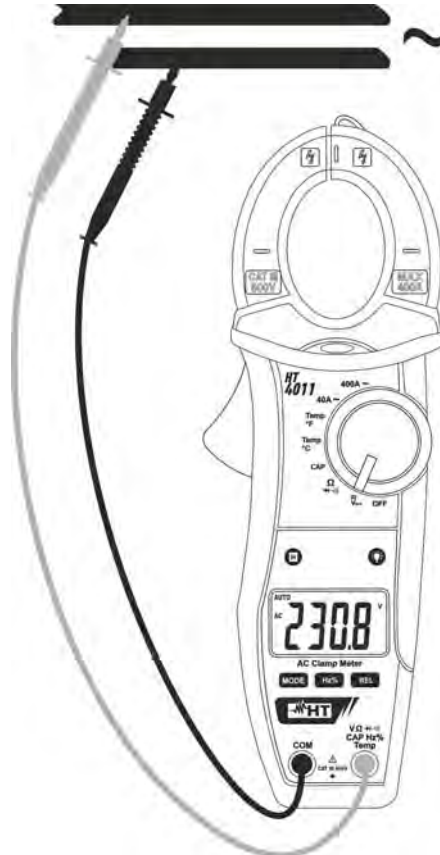
Abb. 4: Verwendung der Zange für Wechselspannungsmessung
