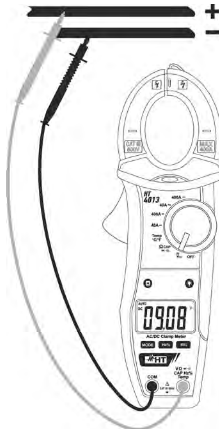
Abb. 3: Verwendung der Zange für Gleichspannungsmessung
