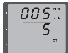
Abb. Programmier-Modus Stromwandler Über die Tasten 1 und 2 können Primär- und Sekundärstrom geändert werden (vgl. Seite 39).
