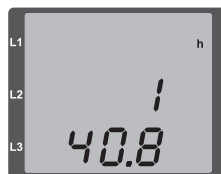
Abb. Messwertanzeige Betriebsstundenzähler
