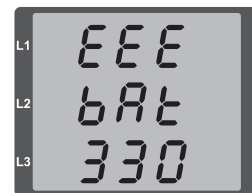
Abb. Uhren-/Batteriefehler mit Nummer 330 (Uhr steht und muss gestellt werden).
