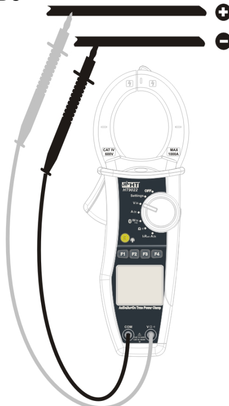
Fig. 5: misura di Tensione DC
