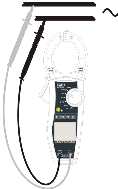
Fig. 6: misura di Tensione AC+DC
