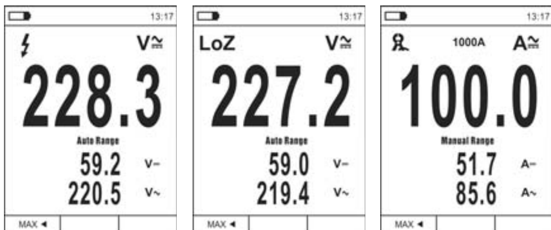
Fig. 6: Descrizione misura tensione e corrente AC+DC
