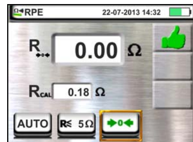
Fig. 7 : Compensation de la résistance des câbles simples et de l'embout à distance
