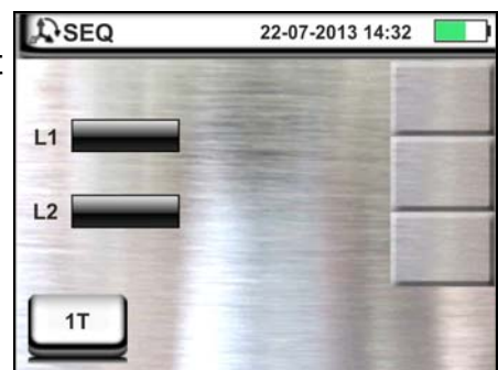
Fig. 23 : Vérification du sens cyclique des phases 2T avec borne et embout à distance
