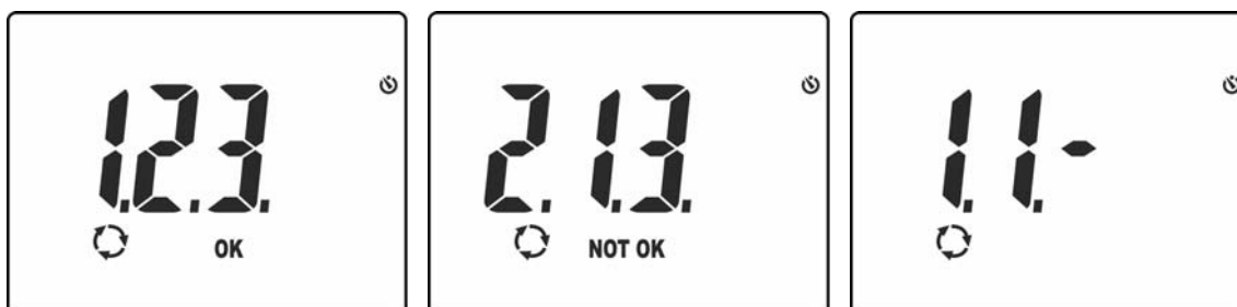
Fig. 16: Esiti del test di sequenza e concordanza delle fasi
