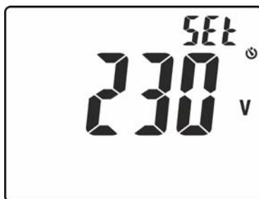
Fig. 6: Impostazione tensione nominale nelle misure di Loop
