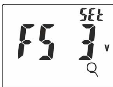
Fig. 7: Impostazione fondo scala pinza flessibile
