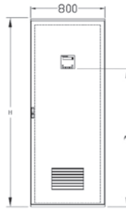
ES8206 (dimensions in mm): H = 2,020, W = 800, D = 600, A1 = 537 A2 = 63, A3 = 737, A4 = 62, A5 = 1,480
