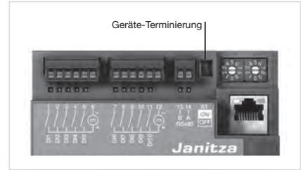
Abb.: Modbus- / RS485 Terminierung
