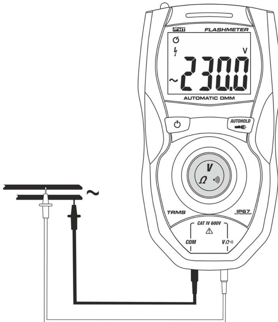
Fig. 4: Uso dello strumento per misura di Tensione AC
