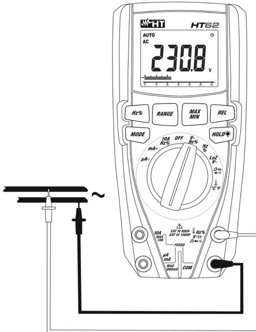
Fig. 3: Uso dello strumento per misura di Tensione AC
