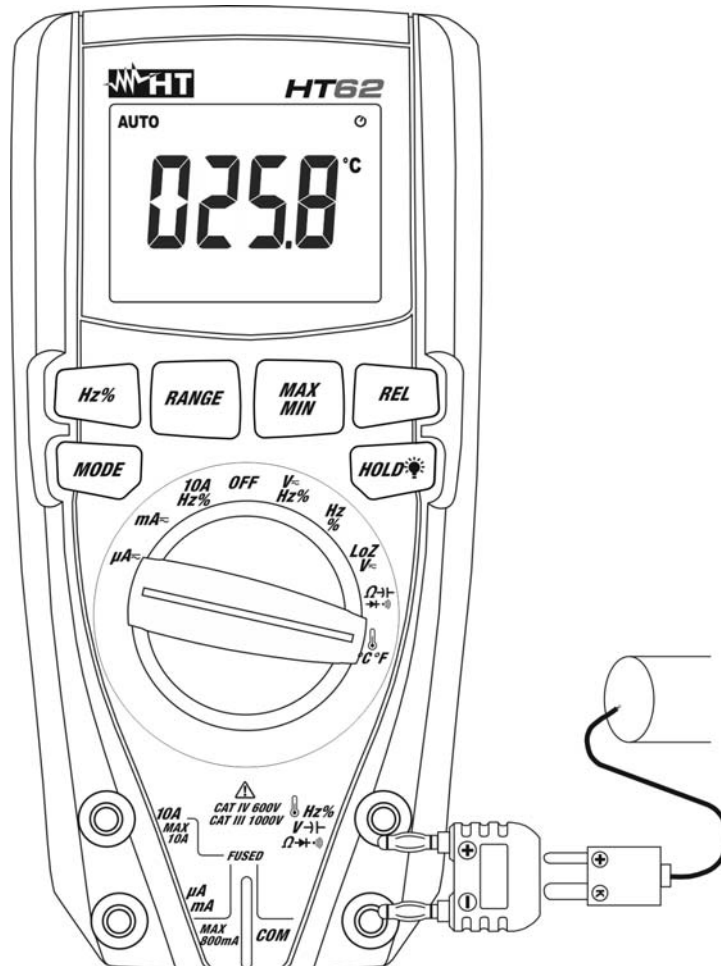
Fig. 9: Uso dello strumento per misura di Temperatura
