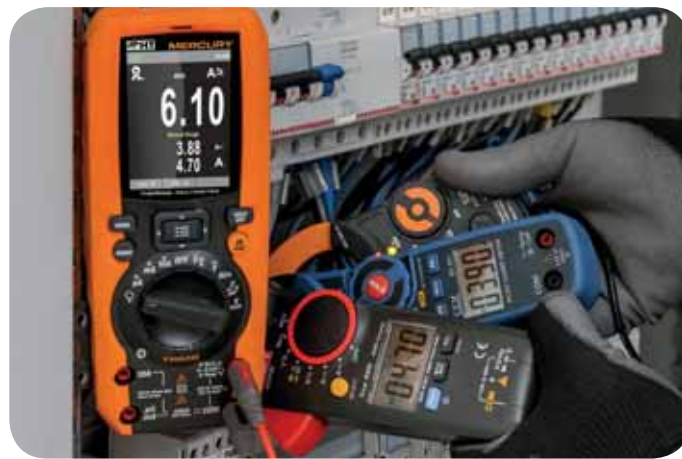
Confronto fra letture: 3.9A con pinza RMS, 4.7 A con pinza TRMS, 6.1A (lettura corretta) con pinza AC+DC.
