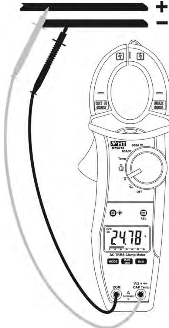
Fig. 4: Uso de la pinza en medidas de Tensión CC
