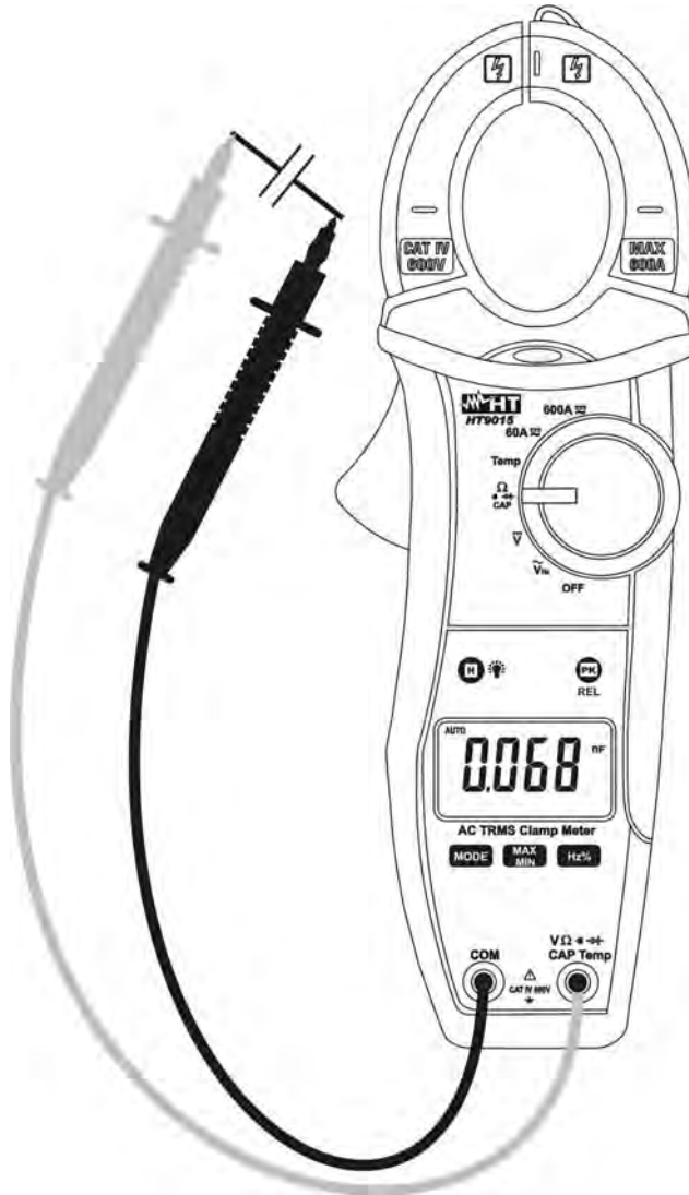
Fig. 7: Uso de la pinza para medidas de Capacidades
