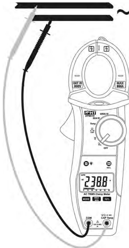
Fig. 3: Uso della pinza in misura di Tensione AC
