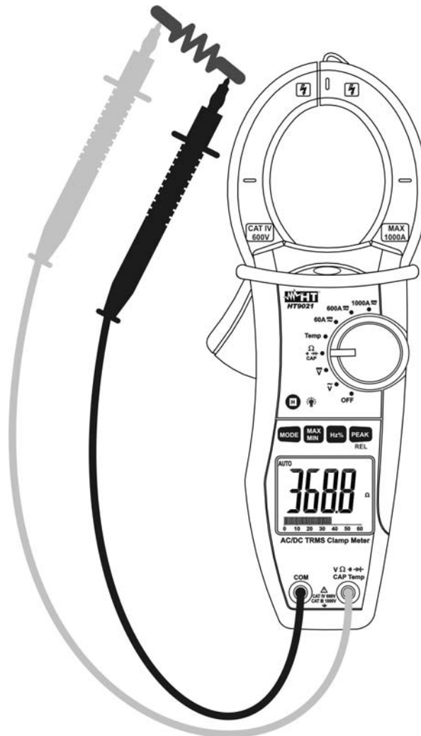
Abb. 4: Messung von Widerständen
