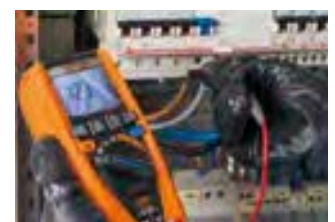
Drehfeldrichtung mit 1-phasiger Methode.
