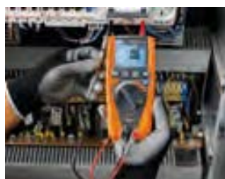
LoZ Funktion eliminiert Streuspannungen
