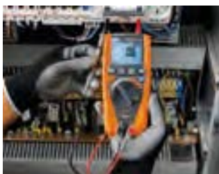
LoZ Funktion eliminiert Streuspannungen
