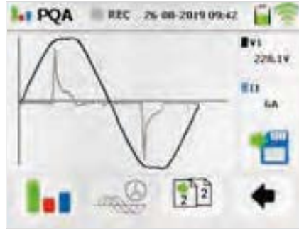
Netzanalyse Scopefunktion Spannung und Strom
