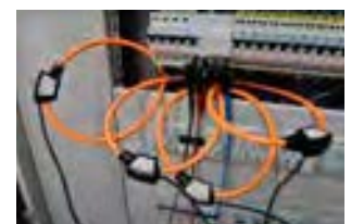
Lieferumfang: inkl. 4 flexible Stromwandlern (300 A / 3000 A)
