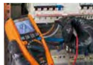
Drehfeldrichtung mit 1-phasiger Methode.
