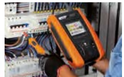
COMBI G3 im Einsatz mit externer Prüfsonde PR400 (Start/Stop)
