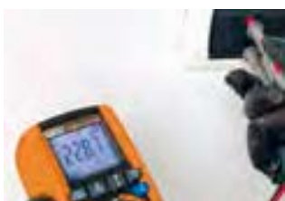
LoZ Funktion eliminiert Streuspannungen.
