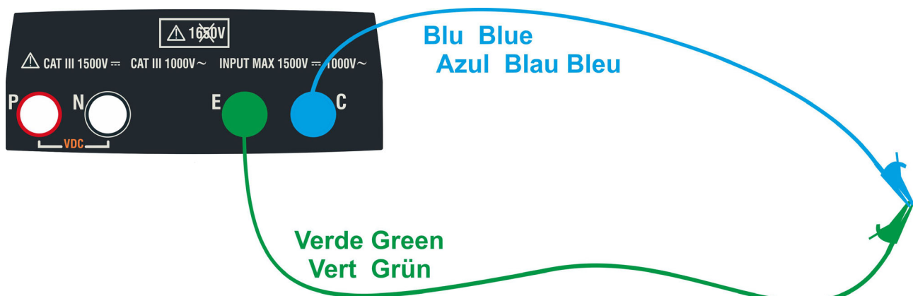
Abb. 4: Kompensation des Widerstands der Messkabel
