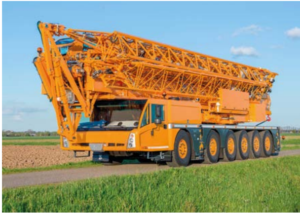
E-Krane im Kommen: Kranhersteller setzen zunehmend auf Kräne, die vollelektrisch heben, wie dieser sechsachsige mobile Turmdrehkran. Auch Kranmodelle, die elektrisch heben und fahren, sind bereits verfügbar. ( www.spieringscranes.com )
