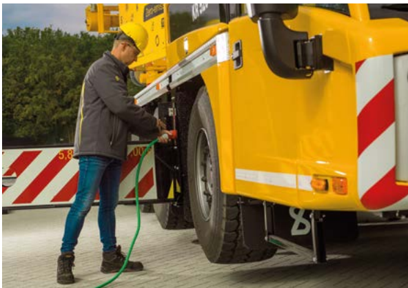
Stecker rein: Elektrische Baumaschinen können über AC- oder DC-Ladestationen betankt werden.
