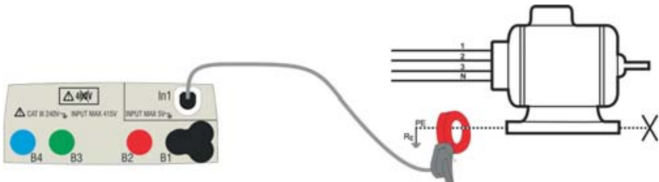
Fig. 27: Misurazione diretta della corrente di dispersione in impianti trifase
