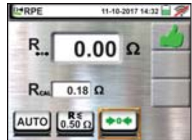
Fig. 7: Compensazione della resistenza dei cavi singoli e del puntale remoto
