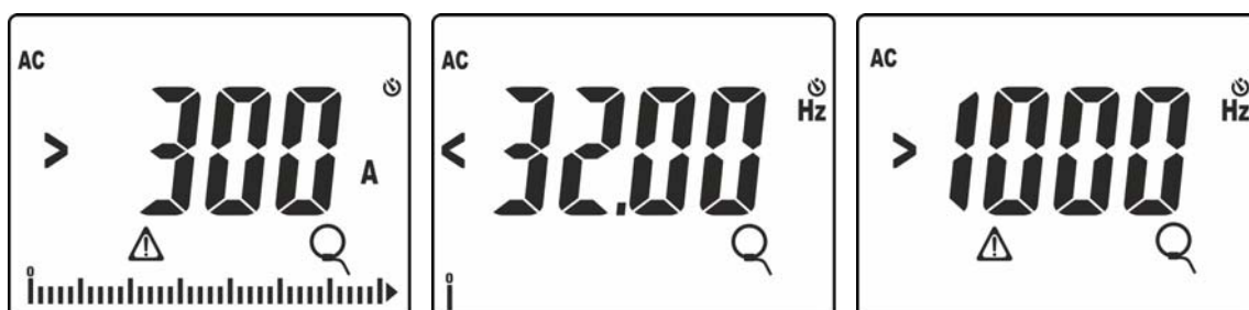
Abb. 41: Anormale Situationen bei der Strommessung mit Strommesszangen
