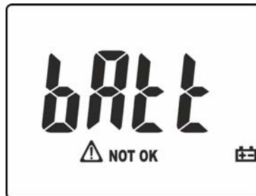
Abb. 45: Anzeige für niedrigen Batterieladezustand
