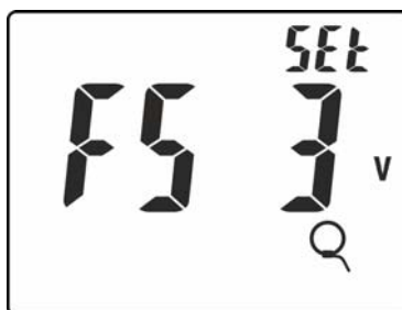
Abb. 7: Messbereich für Flexiblen Stromwandler einstellen
