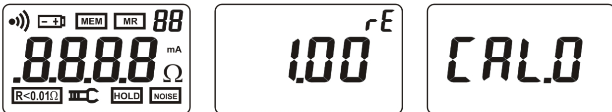
Fig. 2: Sequenza videate all'accensione dello strumento
