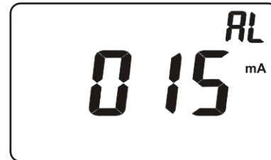
Fig. 39: Impostazione soglie di allarme per misura di Resistenza e Corrente
