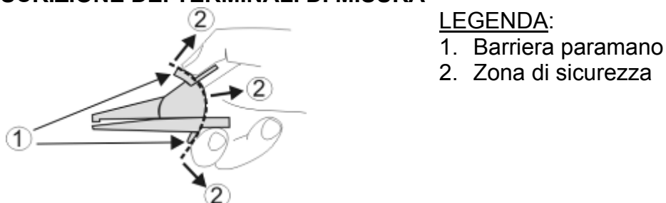
Fig. 4: Descrizione dei terminali di misura
