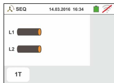
Fig. 24: Verifica del senso ciclico delle fasi 2T con terminale e puntale remoto
