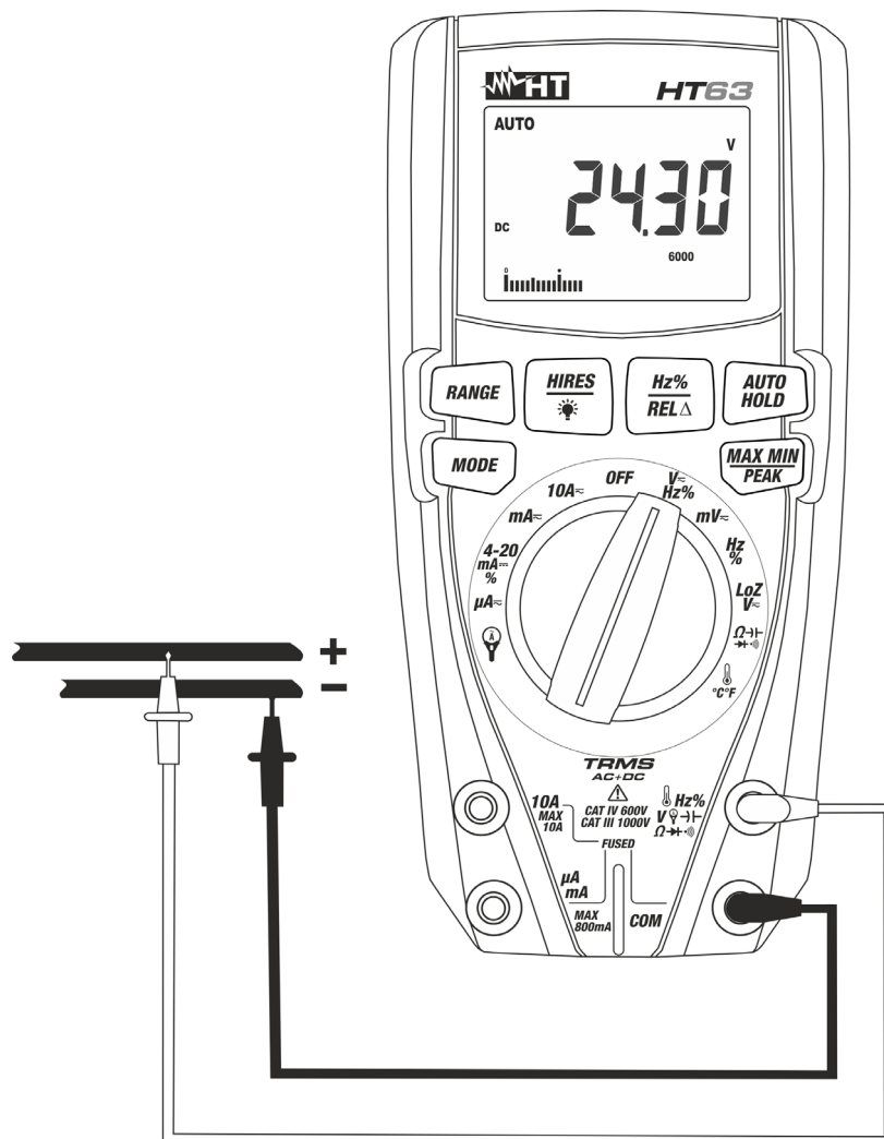
Abb. 2: Verwendung des Gerätes für Gleichspannungsmessung
