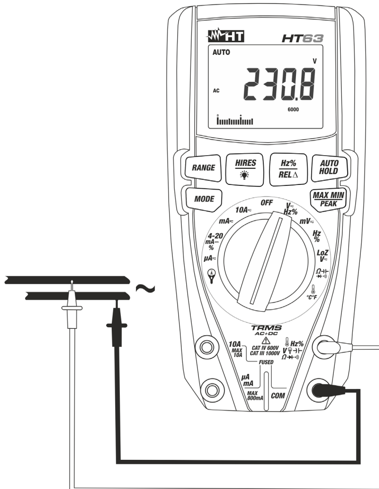
Abb. 3: Verwendung des Gerätes für Wechselspannungsmessung
