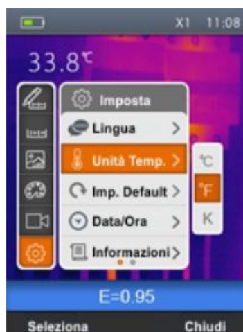
Abb. 9: Einstellung der Messeinheit der Temperatur
