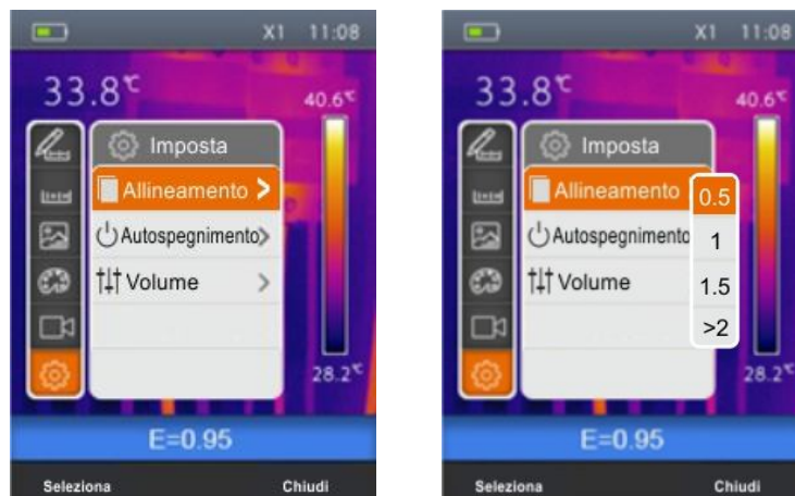
Abb. 13: Einstellung des Ausrichtungsabstands
