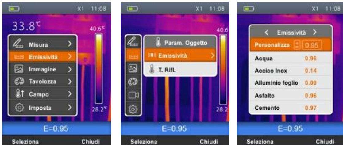
Abb. 17: Einstellung der Emissivität des Geräts
