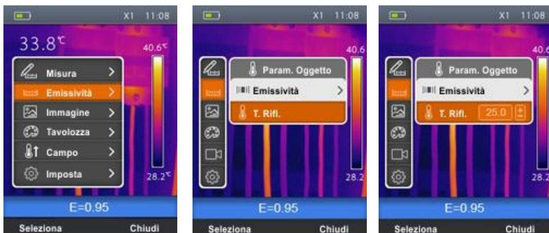
Abb. 18: Einstellung der reflektierten Temperatur am Gerät
