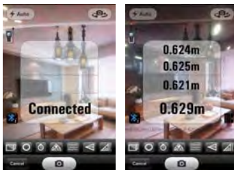
Fig. 5: Collegamento e misura distanza
