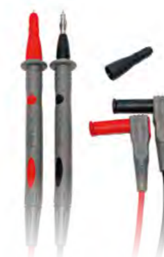
CODE HA000174 KIT4000A PAIRE DE CORDONS À POINTES DE 2 MM COMPATIBLES AVEC LES MULTIMÈTRES ET LES PINCES AMPÈREMÉTRIQUES Échelle de mesure: 10A / 1000V Catégorie de mesure: CAT II 1000V Longueur totale cordon: 13.5 cm Longueur cordon: 1.9 cm Diamètre cordon: 2 mm Longueur du câble: 1.5 m Diamètre banane: 4 mm à 90°
