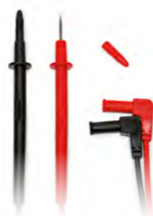
CODE HA000174 KIT4000A PAIRE DE CORDONS À POINTES DE 2 MM COMPATIBLES AVEC LES MULTIMÈTRES ET LES PINCES AMPÈREMÉTRIQUES Échelle de mesure: 10A / 1000V Catégorie de mesure: CAT II 1000V Longueur totale cordon: 13.5 cm Longueur cordon: 1.9 cm Diamètre cordon: 2 mm Longueur du câble: 1.5 m Diamètre banane: 4 mm à 90°
