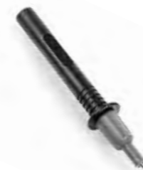
CODE HA40400# 404-IEC# # = N (noir) - B (bleu) - V (vert) - R (rouge) CORDON DE MESURE AVEC CAPUCHON DE PROTECTION EXTRACTIBLE Échelle de mesure: 36A / 1000V Catégorie de mesure: CAT IV 600V / CAT III 1000V Longueur totale: 11.5 cm Longueur cordon: 1.9 cm Diamètre cordon: 4 mm Diamètre banane: 4 mm
