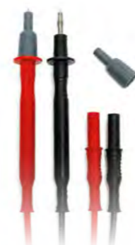
CODE HA431200 4312-2 PAIRE DE CORDONS À POINTE 4 MM ET PROTECTION ROUGE/NOIR ET CONNECTEUR BANANE DROIT Échelle de mesure: 20A / 1000V Catégorie de mesure: CAT IV 600V / CAT III 1000V Longueur totale cordon: 15.6 cm Longueur cordon: 1.8 cm Diamètre cordon: 4 mm Longueur de la protection de l'cordon rétractile: 2 cm Longueur du câble: 1.5 m Diamètre banane: 4 mm
