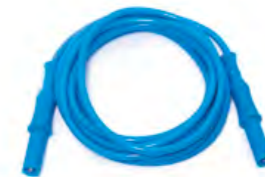
2310-IECIV-200-# # = B (BLEU) CODE HA000048 # = V (VERT) CODE HA000049 # = N (NOIR) CODE HA000047 CÂBLE D'ESSAI, BLEU, 0.75 MM 2 Échelle de mesure: 12A / 1000V Catégorie de mesure: CAT IV 1000V Longueur totale: 2 m Diamètre banane: 4 mm
