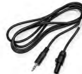
CODE HA000244 C2100 CÂBLE DE CONNEXION T2100 / MACROTESTG Longueur totale: 1.5 m Connecteurs: Jack 3.5 mm - Hypertac
