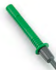
CODE HA40400# 404-IEC# # = N (noir) - B (bleu) - V (vert) - R (rouge) CORDON DE MESURE AVEC CAPUCHON DE PROTECTION EXTRACTIBLE Échelle de mesure: 36A / 1000V Catégorie de mesure: CAT IV 600V / CAT III 1000V Longueur totale: 11.5 cm Longueur cordon: 1.9 cm Diamètre cordon: 4 mm Diamètre banane: 4 mm
