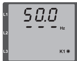
Beispiel 2: Abb. Keine Drehfeldrichtung festgestellt.
