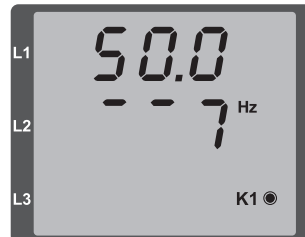
Beispiel 1: Abb. Anzeige der Netzfrequenz (50.0 Hz) und der Drehfeldrichtung.
