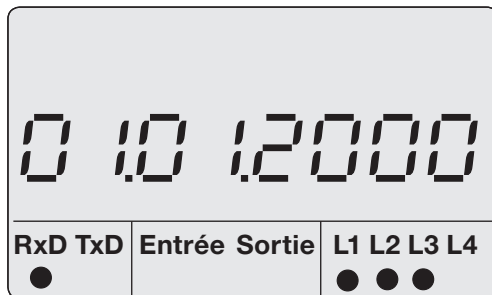
Fig. Affichage des valeurs mesurées avec date.
