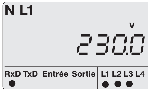
Fig. 19.1 Exemple d'affichage "mode d'affichage". Valeur mesurée affichée :
