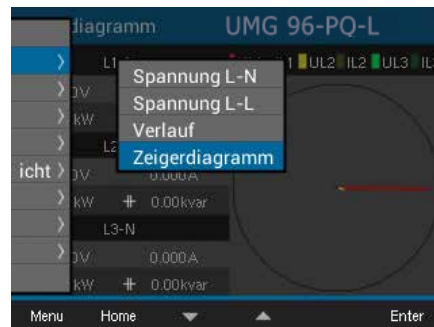
Abb. Untermenüeintrag Zeigerdiagramm
