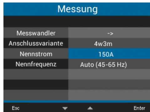
Abb. Fenster Messung mit aktiviertem Eintrag Nennstrom .
