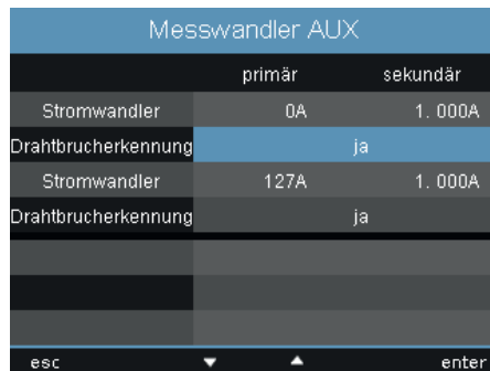
Abb. Überwachung für Differenzstrommessung konfigurieren
