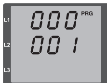
Fig. Mode de programmation de l'affichage de paramètres Les touches 1 et 2 permettent de modifier les différents paramètres (cf. page 46).
