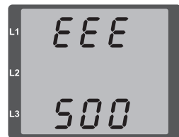
Fig. Message d'avertissement avec numéro 500 (fréquence du réseau)
