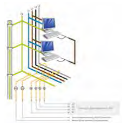
Abb. 8: Kontinuierliche 3-in-1 Überwachung (EnMs-RCM-PQ) eines EMV-optimierten TN-S-Systems
