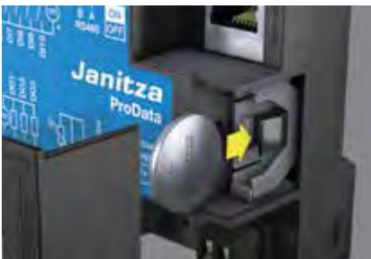
Abb.: Leichtes Austauschen der Batterie während des Betriebs
