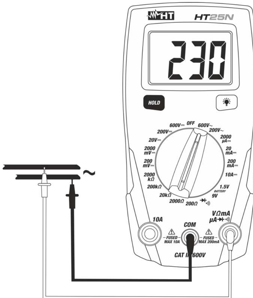
Fig. 3: Uso dello strumento per misura di Tensione AC
