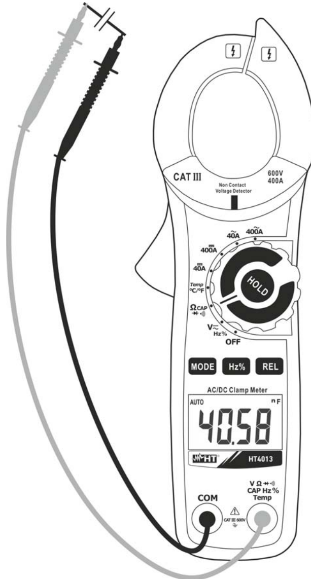
Fig. 6 : Utilisation de la pince pour mesure de capacité
