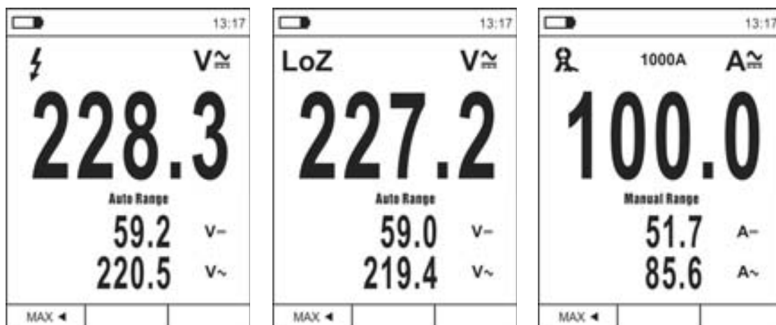
Fig. 6: Descrizione misura tensione e corrente AC+DC
