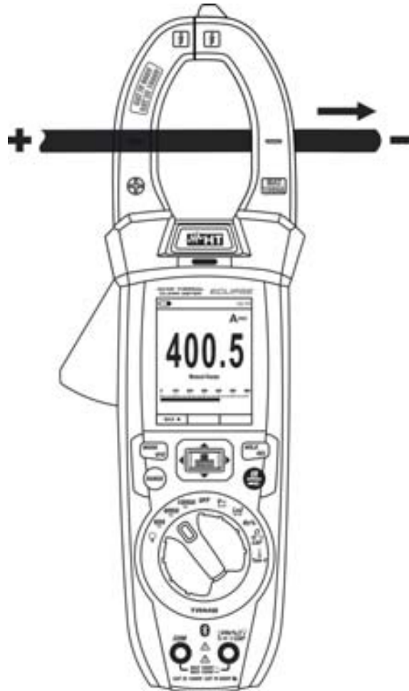
Fig. 31: Uso dello strumento per misura di Corrente DC
