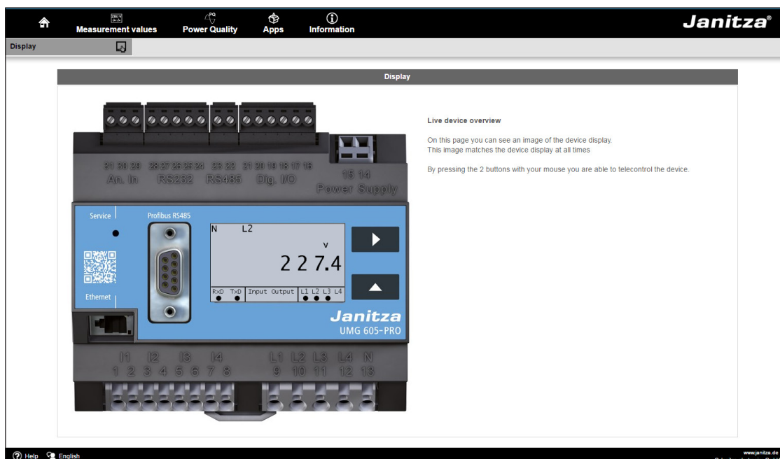
Abb. Bedienung des UMG 605-PRO über die Gerätehomepage
