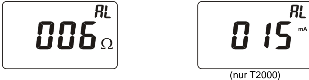
Abb. 39: Einstellung von Alarm-Schwellen bei Widerstands- und Strommessungen
