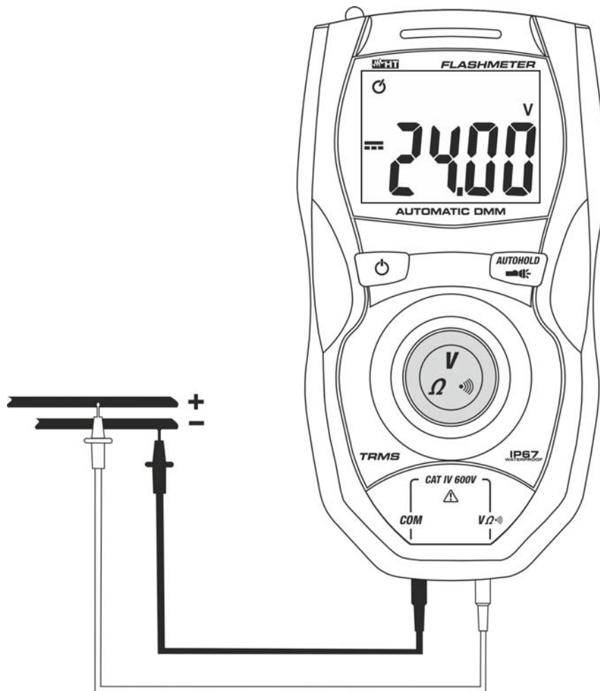
Fig. 3: Utilisation de l'instrument pour la mesure de la Tension DC
