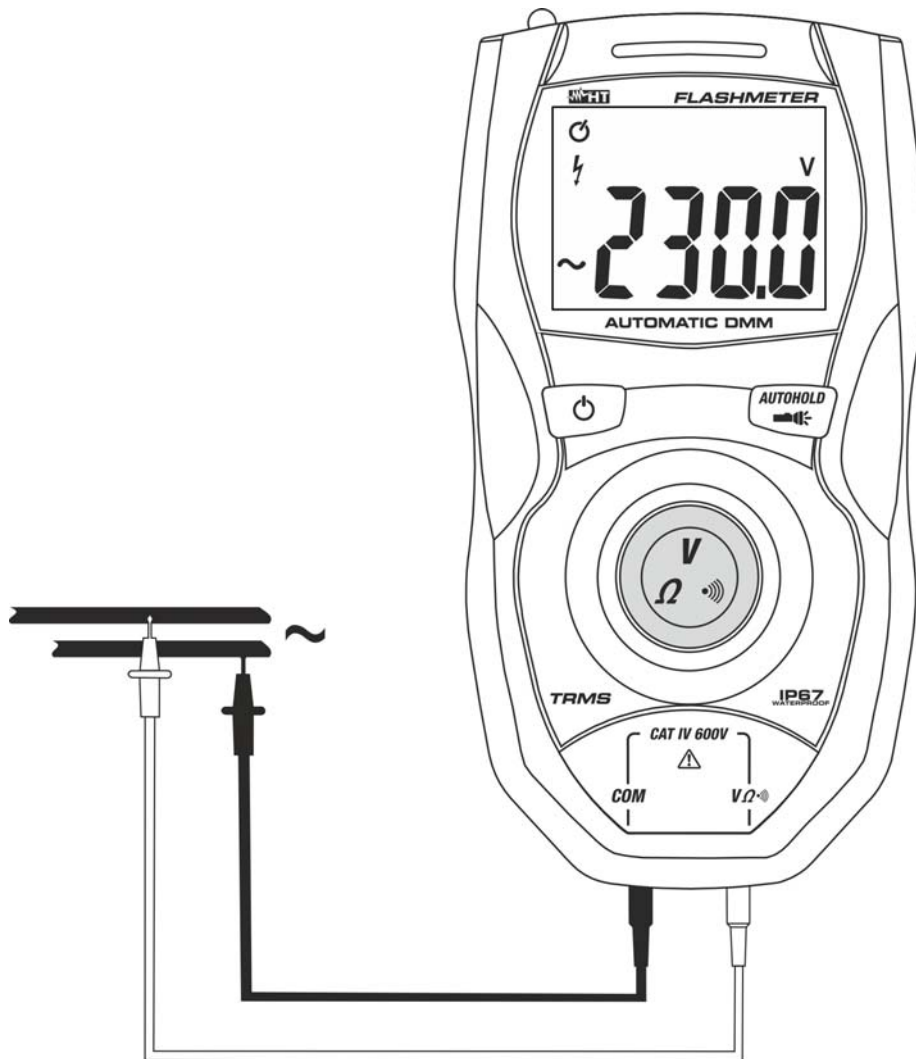
Fig. 4: Utilisation de l'instrument pour la mesure de la Tension AC
