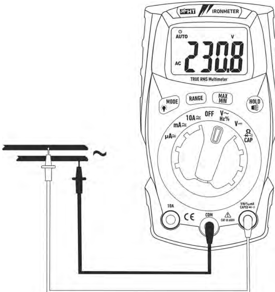
Fig. 4: Uso del instrumento para medida de Tensión CA
