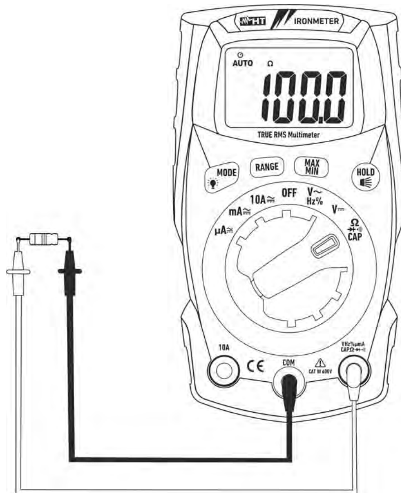
Abb. 5: Verwendung des Gerätes für Widerstandsmessung und Durchgangsprüfung
