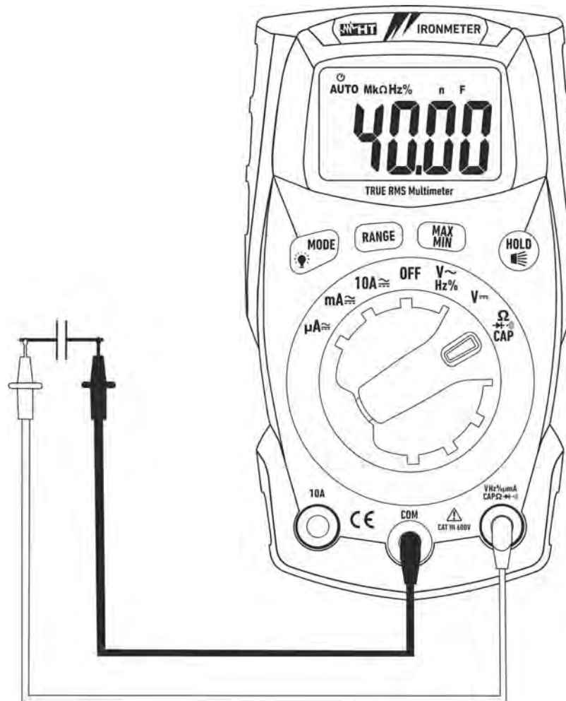
Fig. 7: Uso del instrumento para medida de Capacidades
