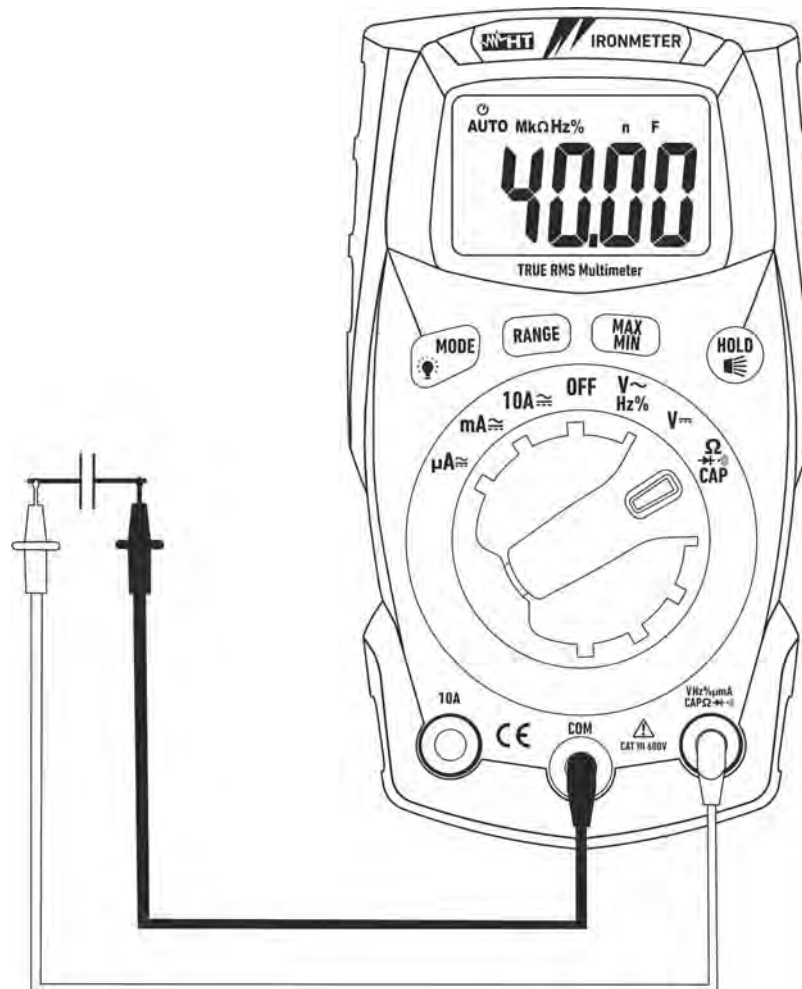
Abb. 7: Verwendung des Gerätes für Kapazitätsmessung
