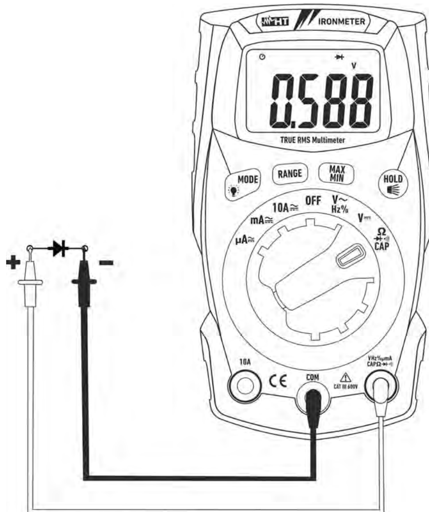
Fig. 6: Uso dello strumento per la Prova Diodi
