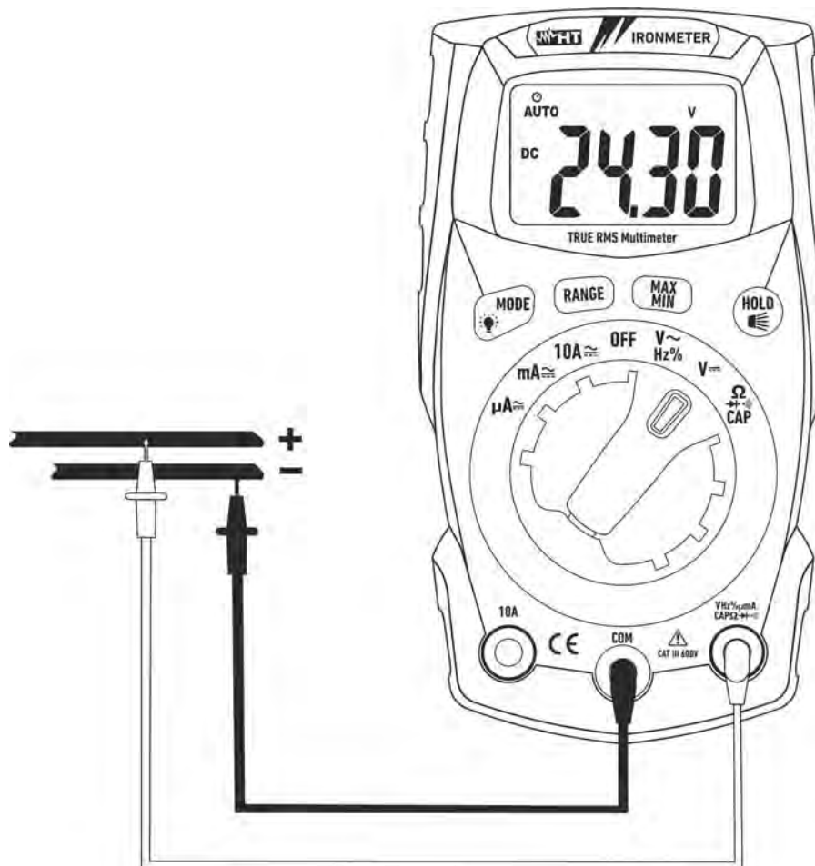
Fig. 3: Uso del instrumento para medida de Tensión CC
