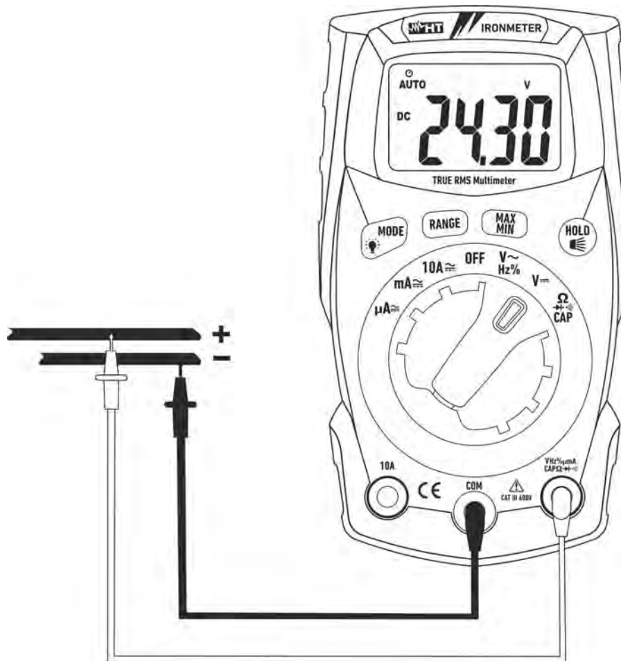
Abb. 3: Verwendung des Gerätes für Gleichspannungsmessung
