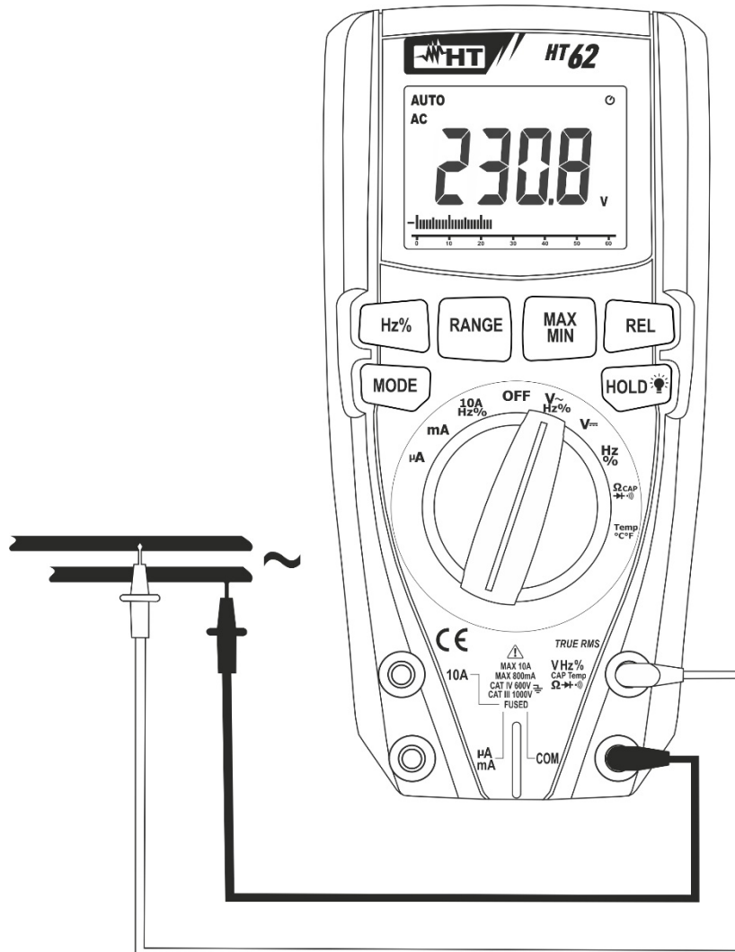
Abb. 3: Verwendung des Gerätes für Wechselspannungsmessung
