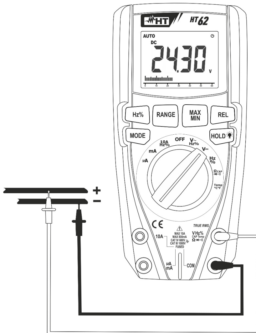
Abb. 2: Verwendung des Gerätes für Gleichspannungsmessung
