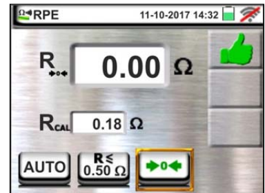
Abb. 7: Kompensation des Widerstandes von Einzelkabeln und Tastkopf
