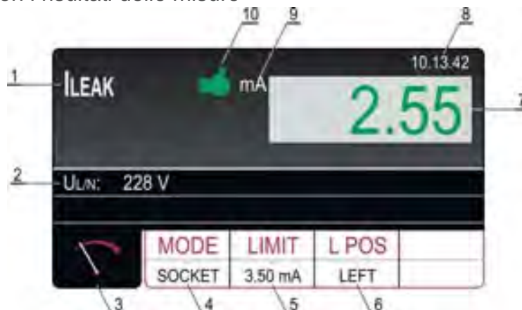
Fig. 75: Videata dei risultati delle prove ILEAK in modo PRESA
