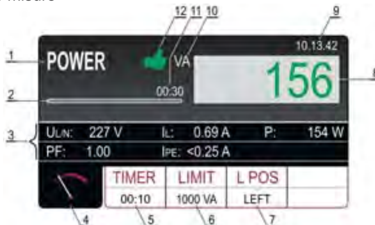
Fig. 64: Schermata dei risultati delle prove di POWER
