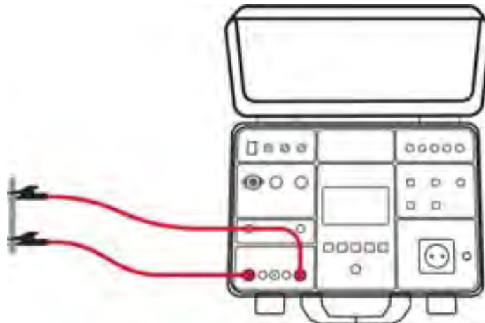
Fig. 26: Calibrazione terminali di misura
